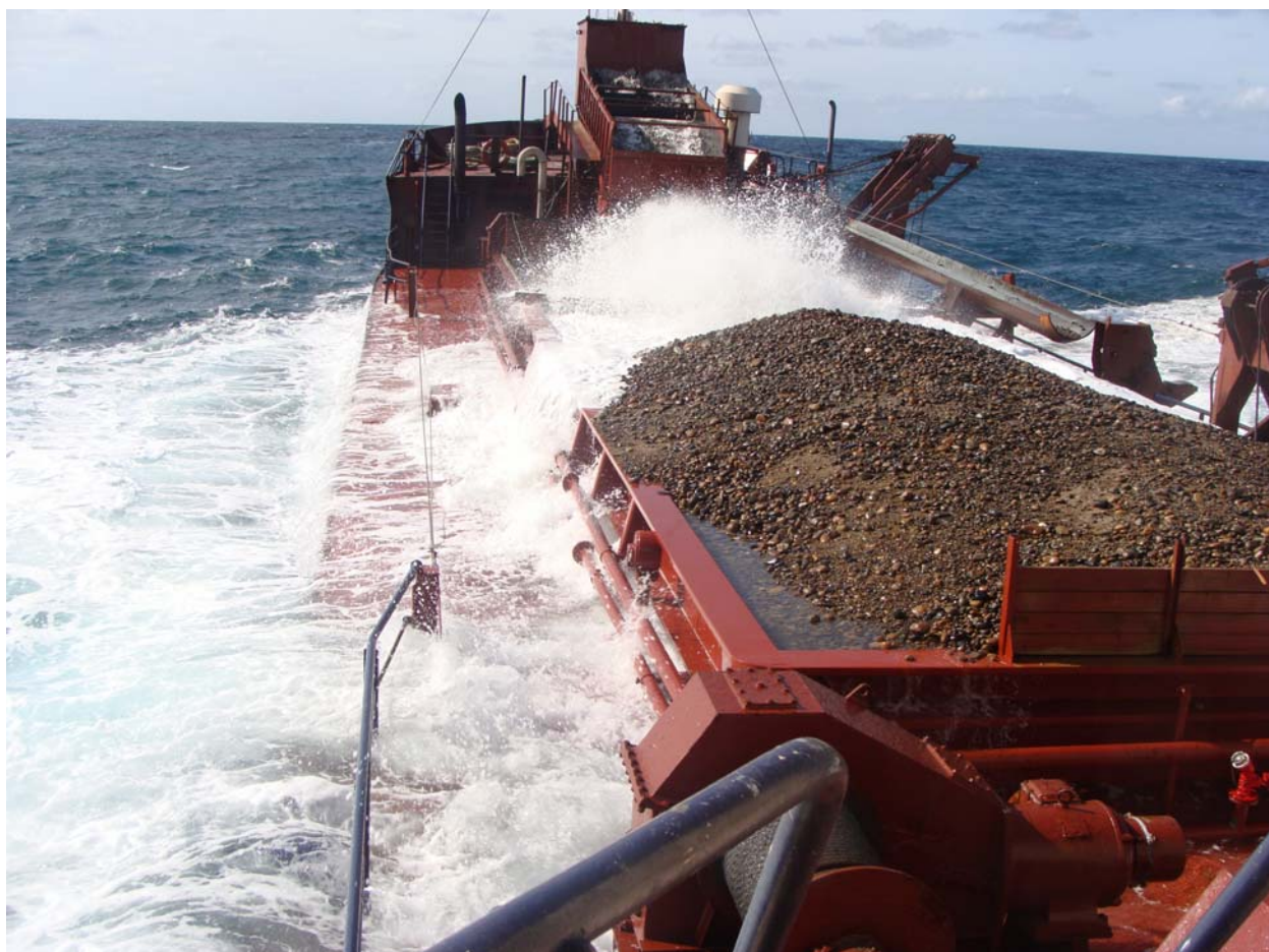
Figur 7. Indvinding af sten og grus fra Jyske Rev, Nordsøen
