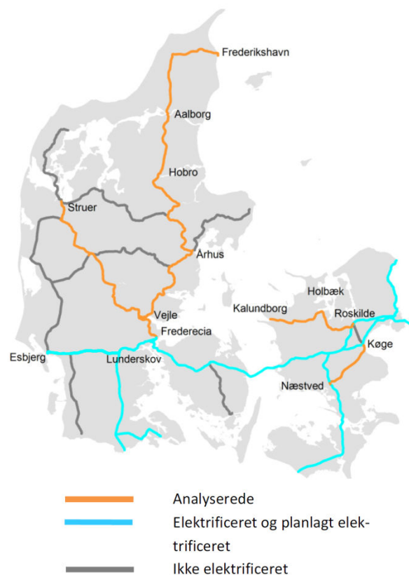
Figur 6: Planlagt elektrificerede strækninger og analyserede strækninger. Kilde: Banedanmark
