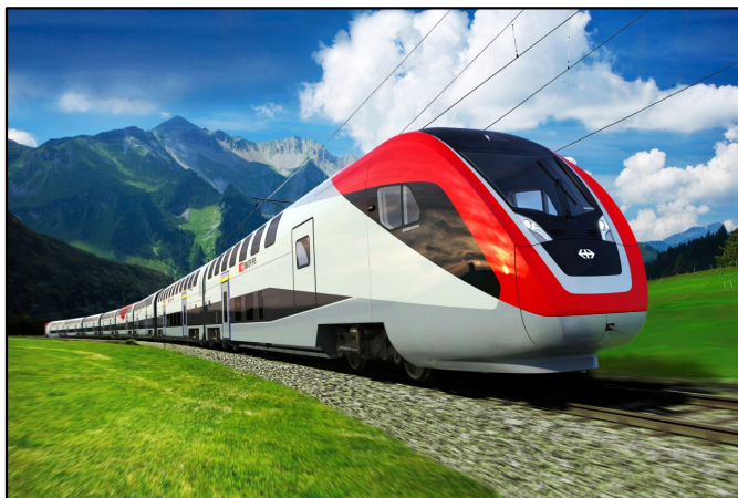
Figur 4: Eksempel på et elektrisk togsæt fra Bombardier Twindexx, der har en tophastighed på 200 km/t. Anvendes i bl.a. Schweiz som har ordre på 59 eksemplarer med levering mellem 2013-2019. Toget er designet i forskellige varianter og findes i en kort version, der har en toglængde på 100m og 340 siddepladser.
