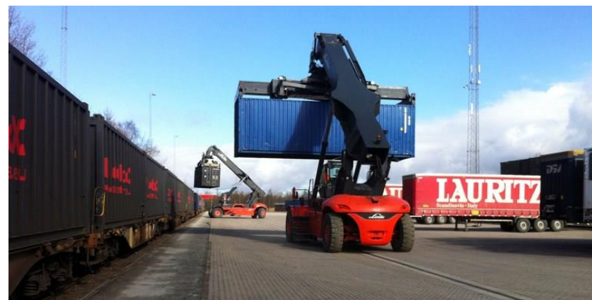
Figur 14. Reachstacker på Padborg kombiterminal
