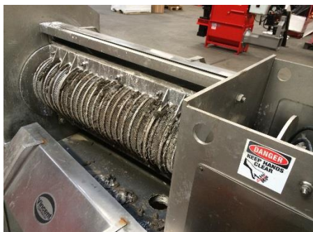
Figur 1. Vincent CP10. På billedet ses det vertikale kammer hvori skruen roterer og hvorfra væsken løber fra under processen.
